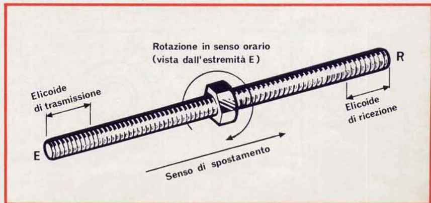
Fig. 1 - Gambo filettato e dado con passo destrorso.
