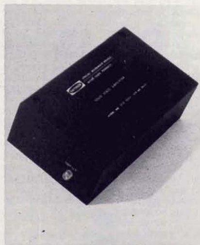
Fig. 4 - Amplificatore a stato solido della Raytheon Co, uscita 1 W, per la gamma 7725 ÷ 8275 MHz (banda C).
