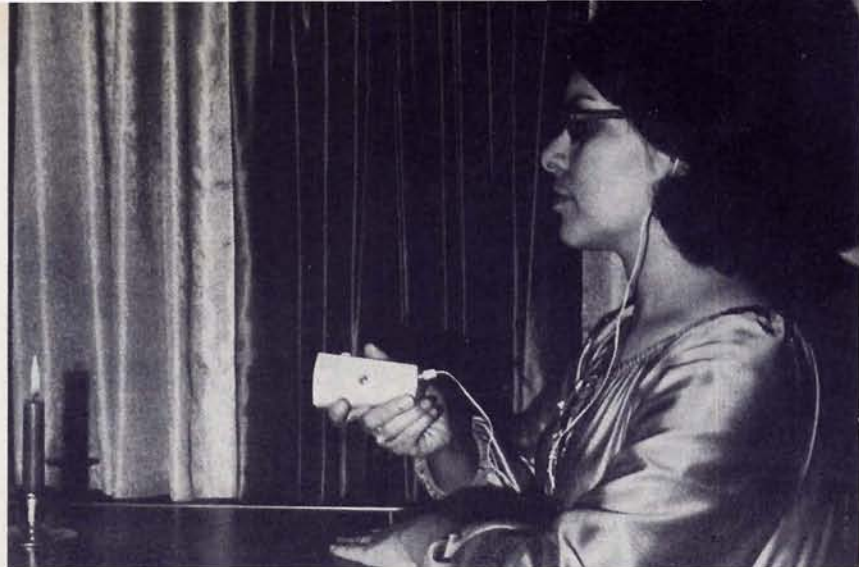
Fig. 7 - Caso pratico di impiego del rivelatore di raggi infrarossi; il trasduttore di ingresso viene orientato verso la fiamma di una candela, il che provoca la variazione del suono udibile.
